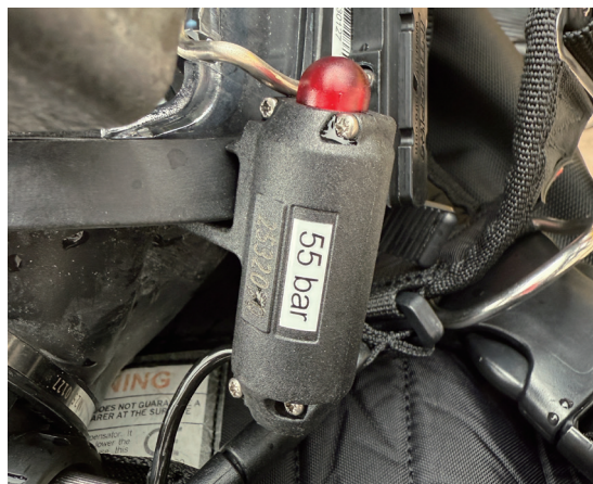
圖 5、殘壓警報裝置 (55bar)
