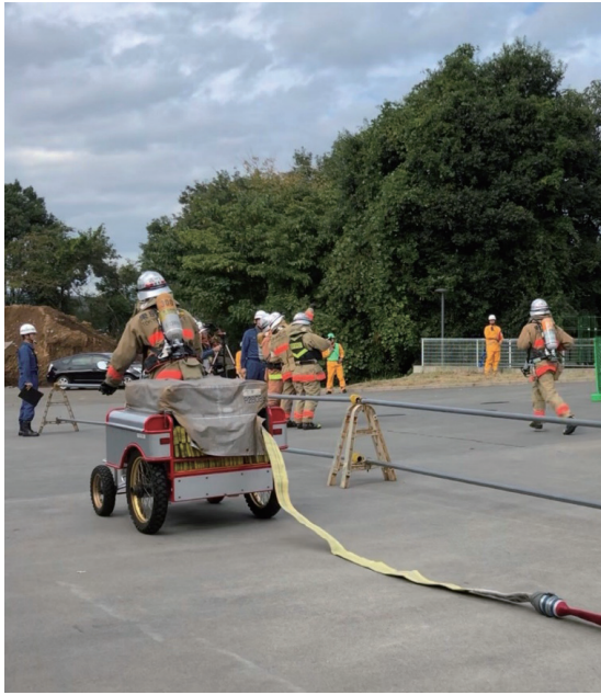
■ 圖 16、電動式水帶推車佈線情形
