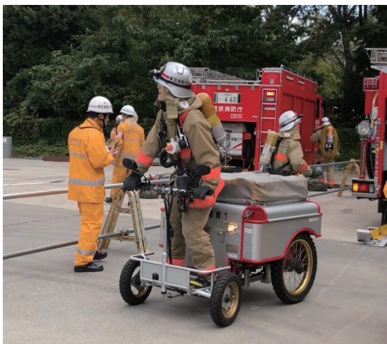
■ 圖 15、操作電動式水帶推車進行佈線
