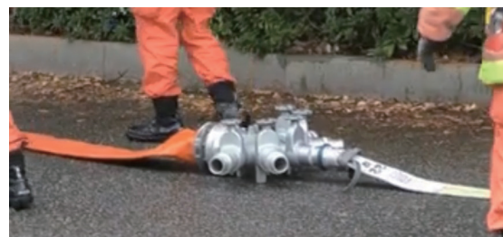
圖 8、150mm 水帶可由專用分水器連接 65mm 水帶（來源：東京消防廳官網）
