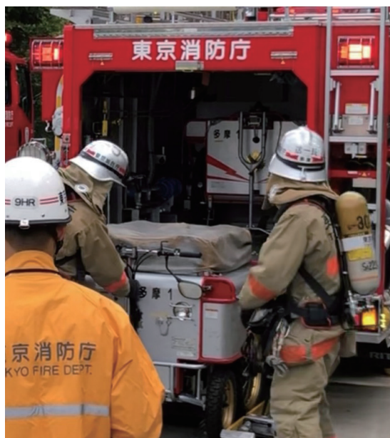
圖 14、2 臺水帶推車收納於中繼車後艙。人力式收納於內側，電動式收納於外側
