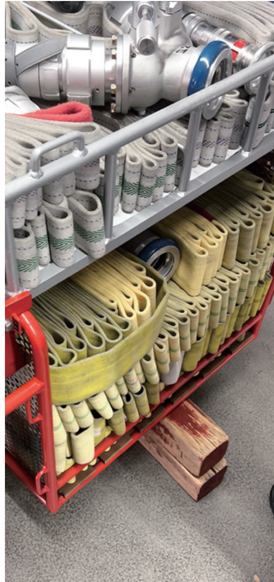
■ 圖 17、推車上層放置入室小水帶，下層放置佈線大水帶
