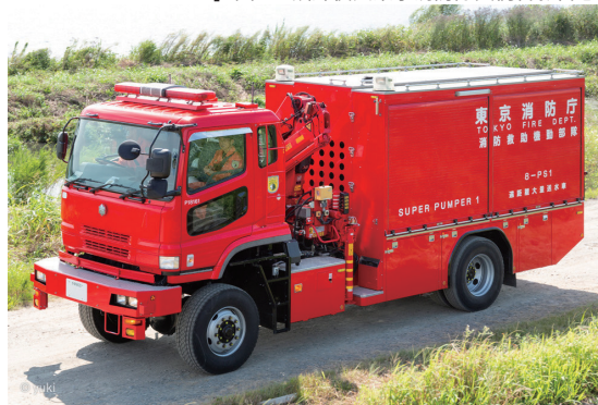
圖 2、東京消防廳遠距離大量送水車（來源：東京消防廳官網）
