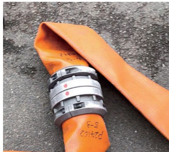
圖 7、150mm 大口徑水帶為螺牙連接式，需以板手固定
