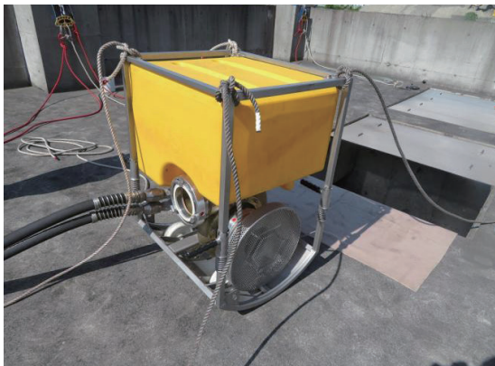
圖 4、送水泵近照（來源：東京消防廳官網）
