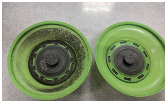
圖 1、肺力閥膜片污損
