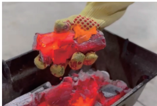
圖 2、經實測，可穿戴手套直接拿取火源
