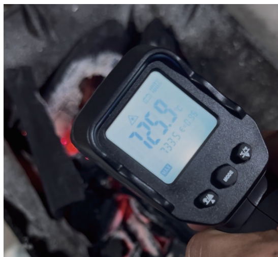
圖 5、使用熱源顯示器測出溫度可達 730 度
