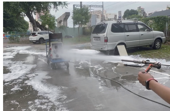
圖 14、本局設備實地測試，亦無導電之虞
