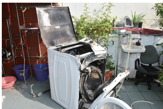
圖 7、滾筒洗衣機受燒後外觀情況，燃燒處侷限於內部
