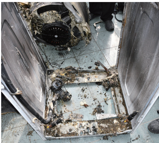
圖 11、將馬達及滾筒取出，發現洗衣機下方處側板附近燒白情況，部分破損元件並未受燒，底座處仍殘留相當多老鼠屎
