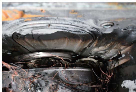
圖 4、滾筒後側轉軸，除鄰近相關電源配線外，該處並未嚴重受燒，鄰近機體僅為燻黑
