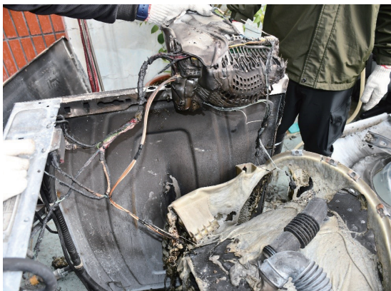
圖 9、拆卸、取出滾筒馬達，其外觀與相關電源配線尚完整，並未嚴重受燒
