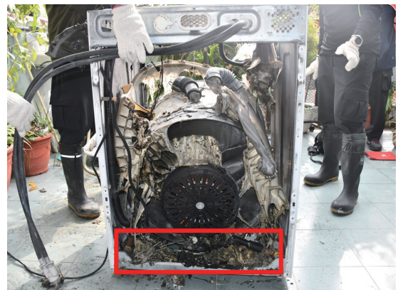
圖 10、將洗衣機背版拆卸後，發現滾筒向下（後方）傾落，下方處可明顯發現囤積相當多老鼠屎（紅框處）的情況
