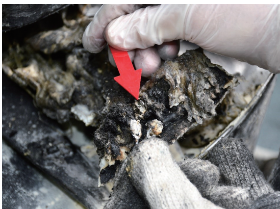
圖 12、經與技師會勘、拆卸後，檢視相關受燒機件情況，研判起火處位於滾筒下方處之「排水馬達」，外觀幾乎已無法辨識
