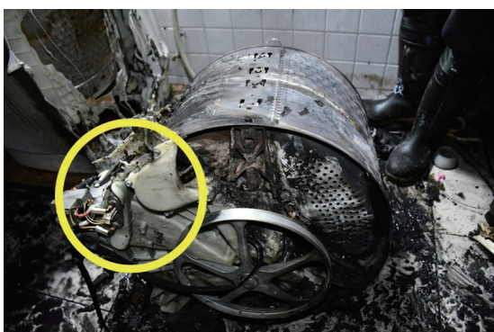
圖 5、將洗衣機滾筒拆下檢視，其下方處馬達與相關電源配線尚完整（黃圈）
