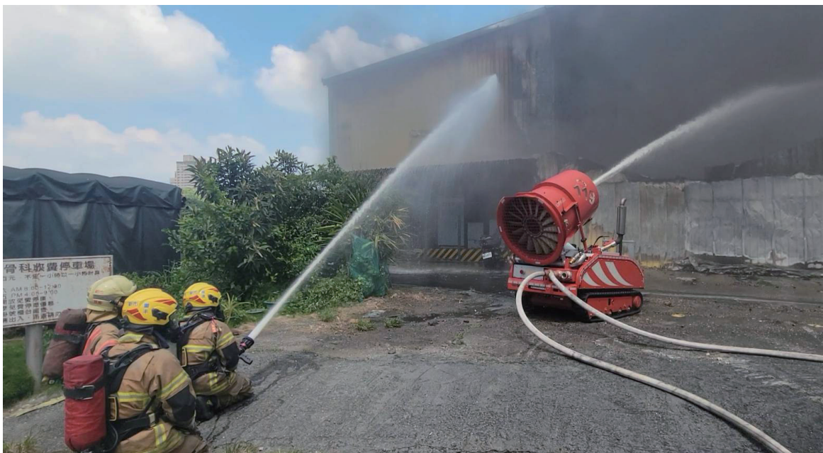
圖 1、有風險疑慮處所，由機器人在前方掩護救災同仁，確保同仁救災安全
