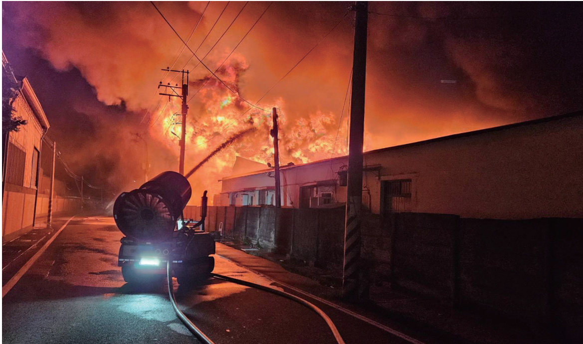
■ 圖 2、機器人可遠距離攻擊火點，壓制火勢
