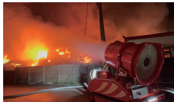
■ 圖 4、可應現場指揮官所需，轉換為細水霧防禦模式，吸收大量輻射熱，避免延燒
