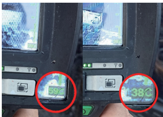
圖 7、TIC 監測鋰電池降溫前後溫度差異
