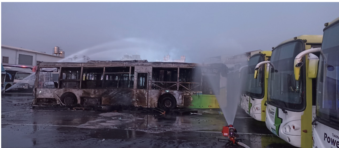
圖 6、電動巴士火警使用砲塔阻絕火勢及降溫
