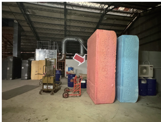
圖 6、比對該公司發泡工廠內部存放之泡棉，可知泡棉半成品（箭頭處）寬度約150公分、高度約210公分、厚度約60公分
