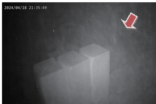
圖 4、於 113 年 4 月○日 21 時 35 分 49 秒可見新擺放之泡棉間有白煙顯著竄出（箭頭處）
