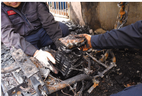
圖 7、起火微型電動二輪車上層電池變形嚴重、下層電池外觀完整
