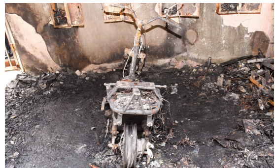
圖 5、起火微型電動二輪車後輪輪胎燒失、鐵製支架變色嚴重
