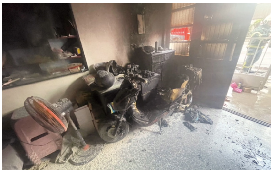
圖 1、微型電動二輪車（舊稱電動自行車）置於客廳，於充電中發生火災
