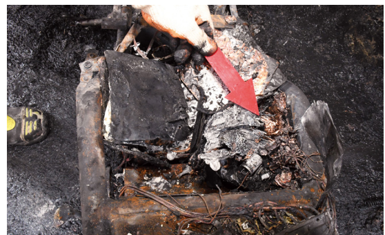
圖 6、起火微型電動二輪車上層電池變形嚴重
