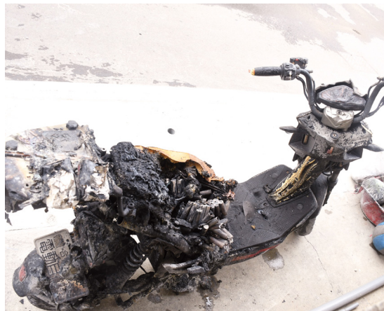
圖 2、微型電動二輪車（舊稱電動自行車）燃燒後情形
