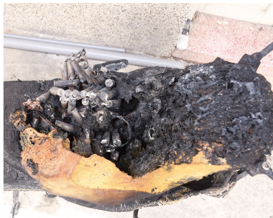
圖 3、微型電動二輪車鋰離子電池組
