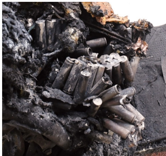
圖 4、微型電動二輪車鋰離子電池組（近拍照）
