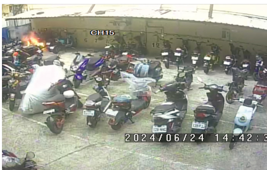
圖 10、監視器畫面顯示時間為 113 年 6 月 24 日 14 時 42 分 37 秒，鐵皮遮雨棚微型電動二輪車車尾處冒出猛烈火勢且火焰伴有噴射火花情形
