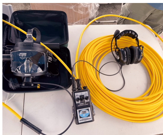
圖 1、水下通訊設備包含全罩式面鏡、發射器、接收器、通訊線
