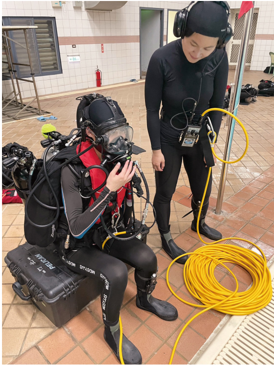
■ 圖 3、潛水人員於岸上先進行水下通訊設備操作測試
