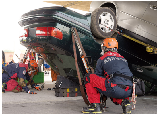
圖 3、熟練使用 V-Strut 穩固車身
