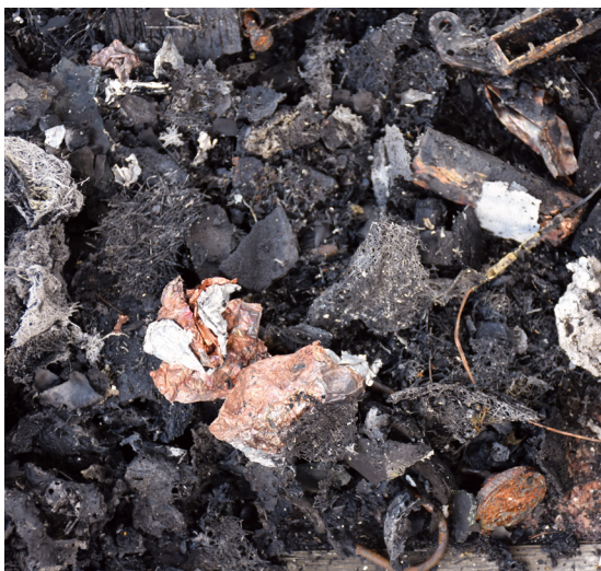
■ 圖 3、起火處附近發現相當多爆開鋰電池芯片、單元及散落組件
