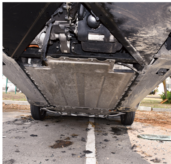
圖 8、電動車底盤處鋰電池組並未受燒情形
