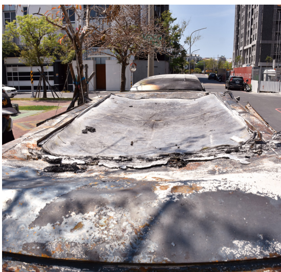
■ 圖 4、裝置於車頂之太陽能板受燒後附著於車頂上
