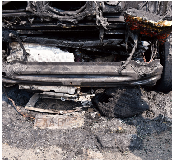
圖 7、電動車燃燒情況與起火處位置
