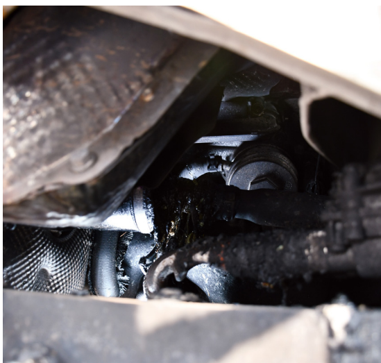
圖 10、檢視電動車車尾之燃油配管有油料洩漏情況
