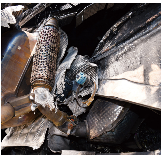
圖 11、車尾燃油配管附近之排氣管與觸媒轉換器等高溫設備
