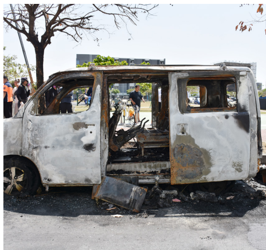
圖 1、燃油廂型車停放位置與受燒後外觀
