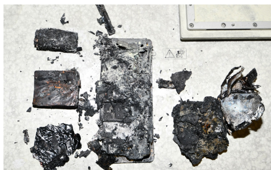
圖 10、手機內部的電池芯外殼膨脹變形，部分鋰電池隔離膜有受燒破損情形
