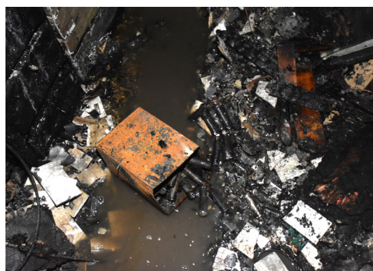
圖 17、客廳靠玄關一帶發現受燒爆開之鋰電池組，金屬上蓋及內部鋰電池飛散，檢視電池芯有由內往外膨脹變形痕跡
