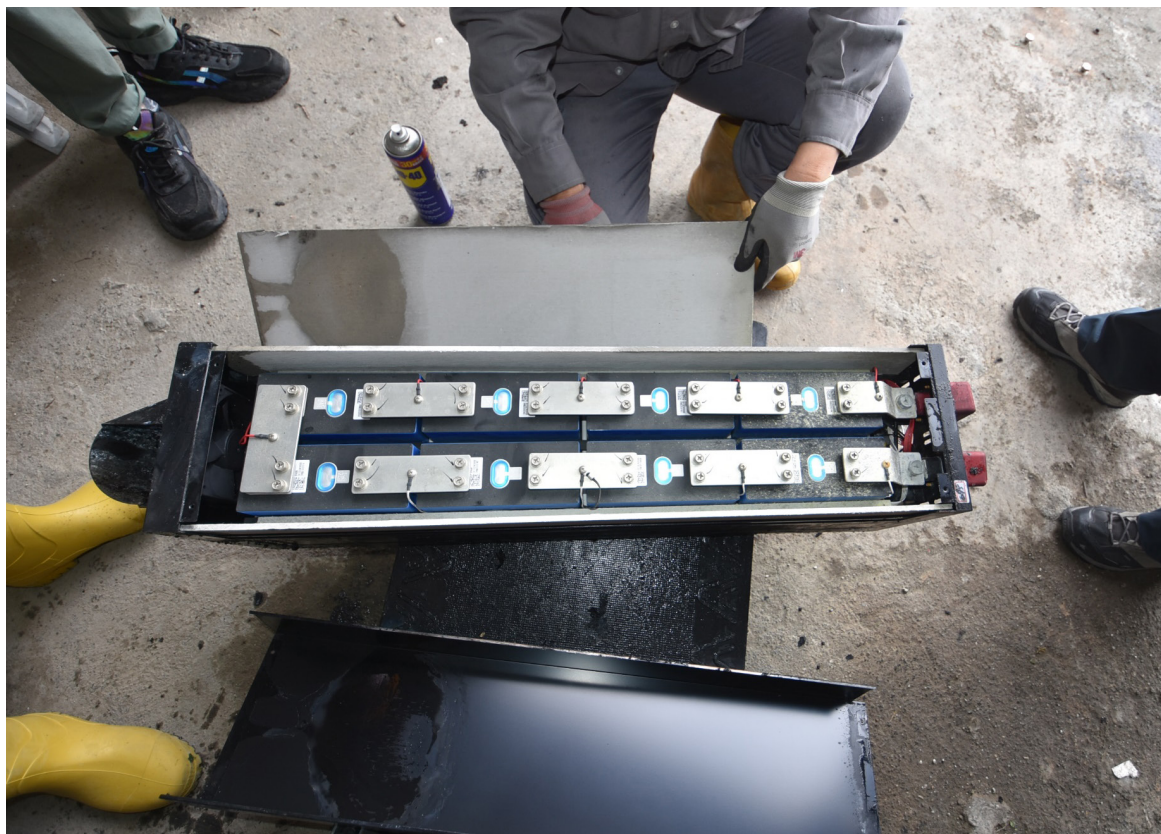
圖 9、電池芯內部電池排列情形
