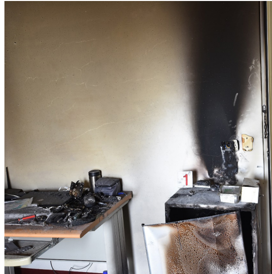
圖 2、冰箱上方行動電源起火燃燒
