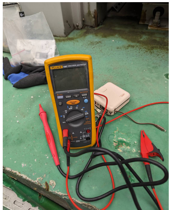
圖 6、高壓絕緣儀測試器
