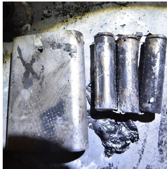
圖 3、鋰電池內部短路造成行動電源外殼及電池芯外殼高溫燒穿情形
