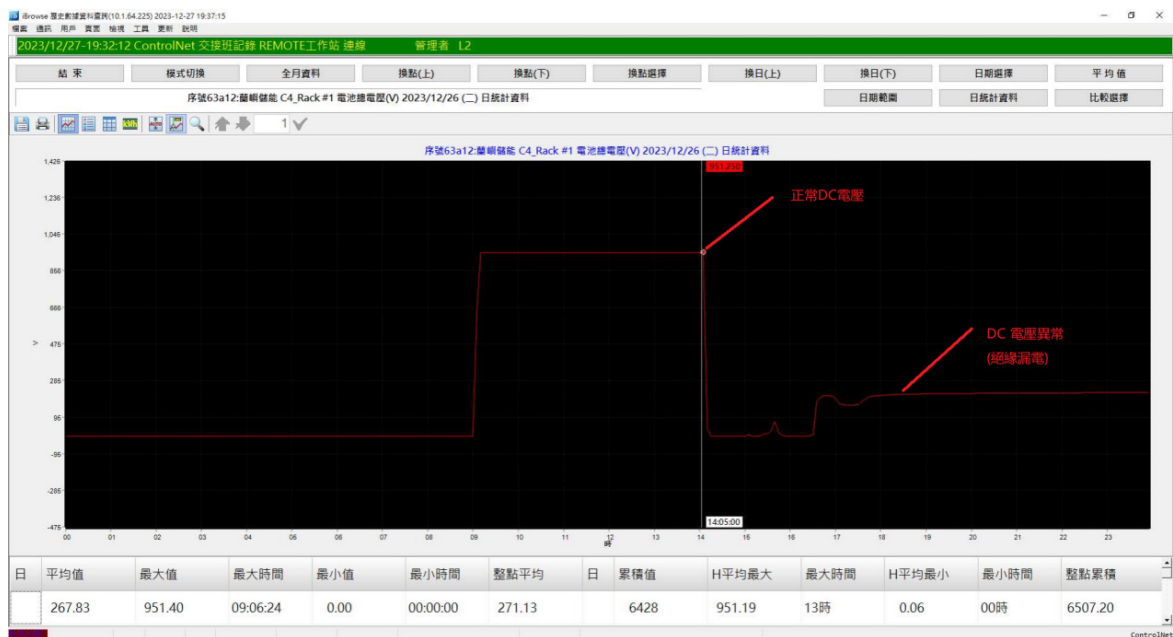
圖 7、電池管理系統電池電壓圖發現電壓異常情形
