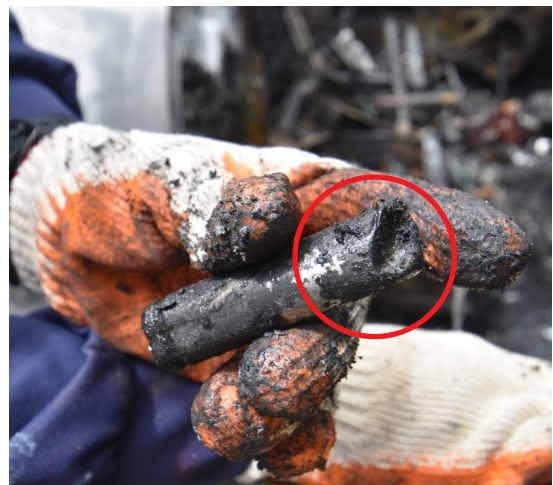
圖 5、電池芯外殼明顯有受力變形情形
