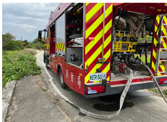
圖 6、運用移動式幫浦中繼供水長距離佈署水線
