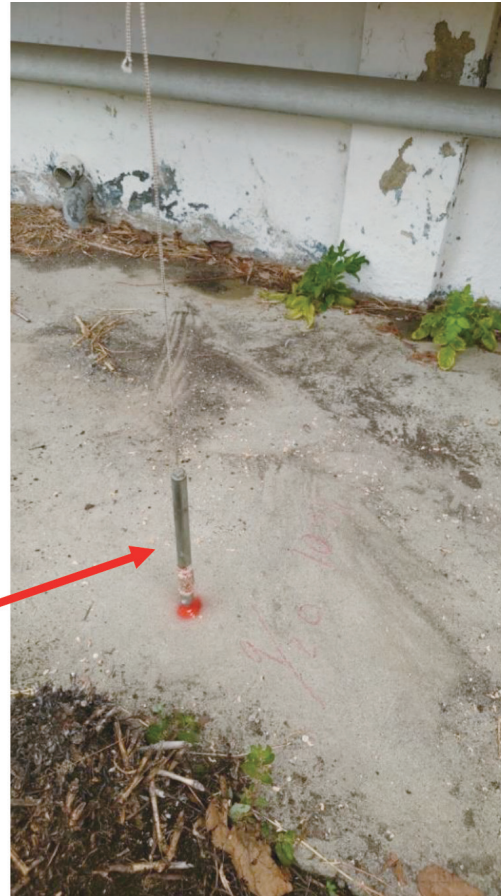
■ 圖 18～19、支撐架構監測與標記方式（2022 年 921 國家防災日演習由筆者單位在花蓮縣消防局訓練基地進行的木架支撐作業現場照片）
