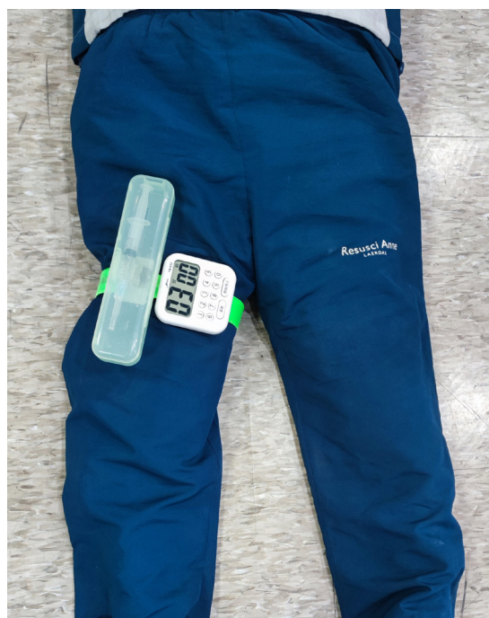
圖 7、主動式 OHCA 救護給藥提醒暨預抽藥物存放裝置固定在下肢使用
