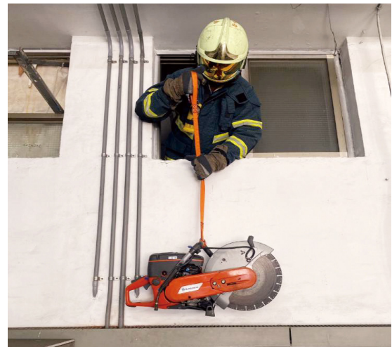
圖 11、多功能救援帶應用於圓盤切割器吊掛運送
