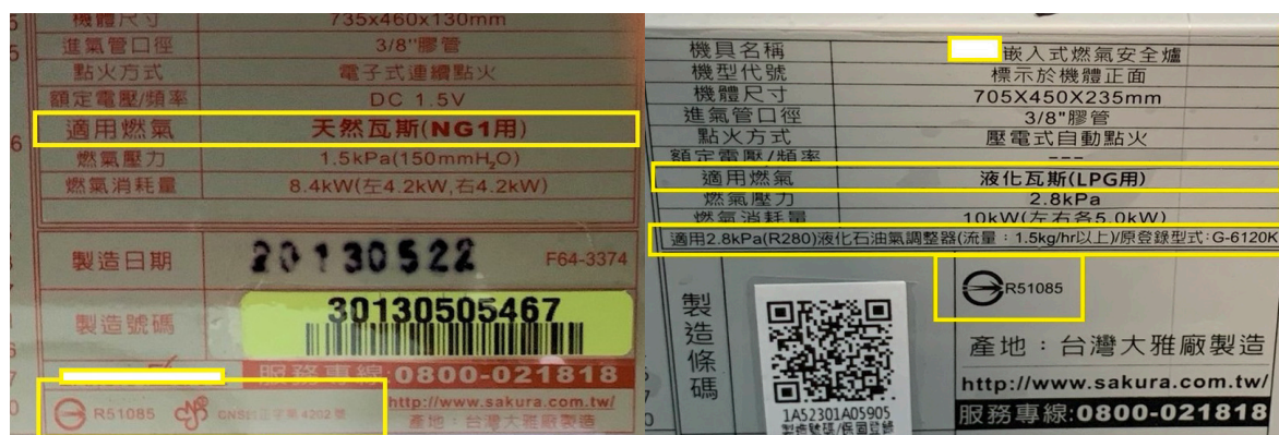
圖 2、（左）標明適用天然瓦斯（NG1 用）、燃氣壓力 1.5 kPa，並貼有合格標識 （右）標明適用液化瓦斯（LPG 用），燃氣壓力 2.8 kPa、應適用 R280 壓力調整器及貼有合格標識（作者拍攝繪製）
