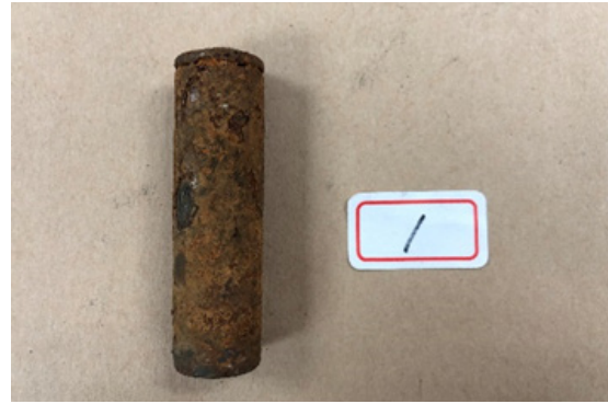
圖 14、編號 1 為鏽蝕最嚴重電池芯
