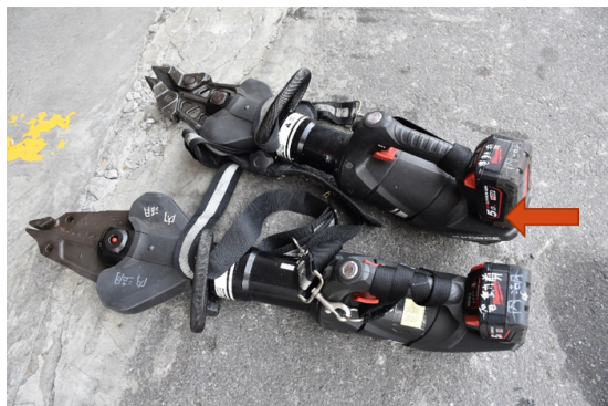
圖 7、破壞工具電池芯位置比對
