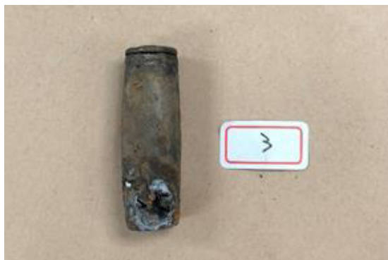
圖 18、外殼下方爆開電池芯
