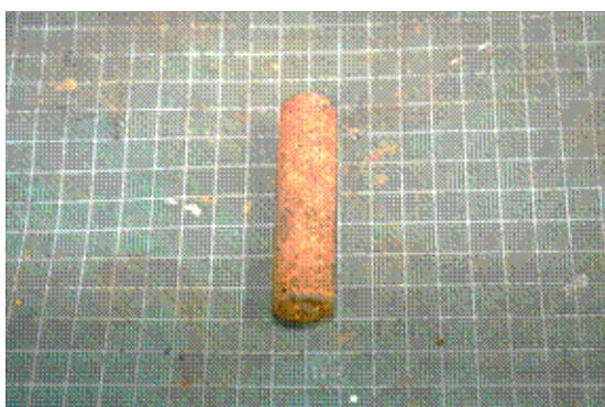
圖 9、電池芯鏽蝕狀況
