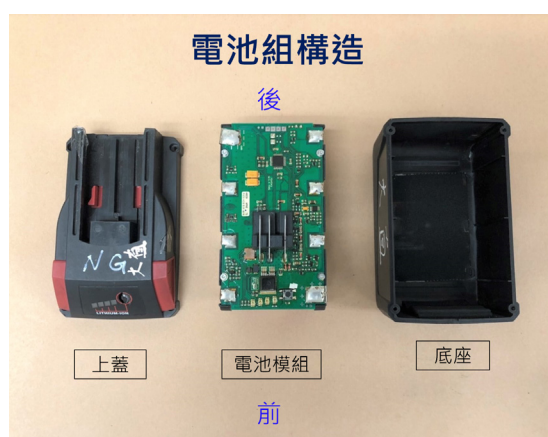
圖 6、電池模組構造
