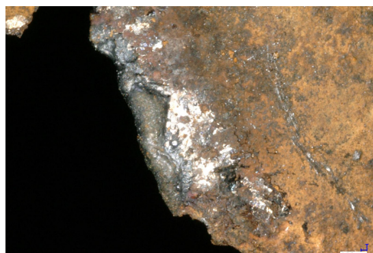
圖 12、電弧燒熔痕跡
