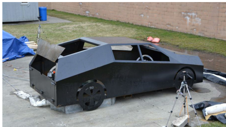
■ 圖 8、車輛火災訓練臺（VFT，Vehicle Fire Trainer）上安裝鋰電池進行火災試驗設定，鋰電池安裝於車輛後部（圖片來源：NFPA FPRF）
